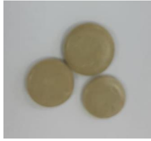
Gambar 3. Komposit mG/SA setelah dikeringkan dan dicetak tekan
