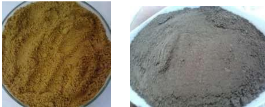
Gambar 2. (a) Prekursor material berupa serbuk sebelum kalsinasi (b) sesudah kalsinasi
