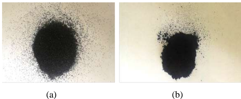
Gambar 2. (a). Pasir besi yang telah dipisahkan dengan batang magnet dan diayak. (b). Pasir besi yang telah disintesis dengan metode kopresipitasi
