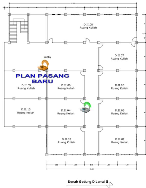
Gambar 2. Denah Lokasi Pemasangan *Access Point*
