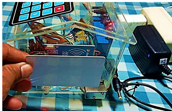
Gambar 3. Pengujian Pembacaan Kartu Tag RFID
