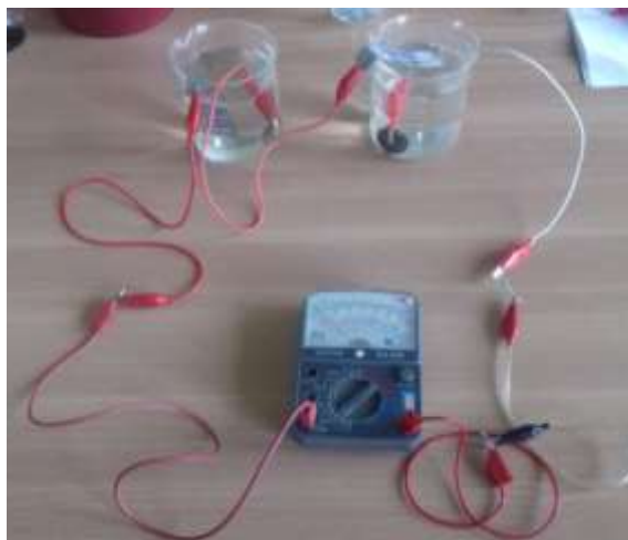
Gambar 1. Rangkaian percobaan pengukuran menggunakan larutan elektrolit air laut (sumber: data pribadi)
