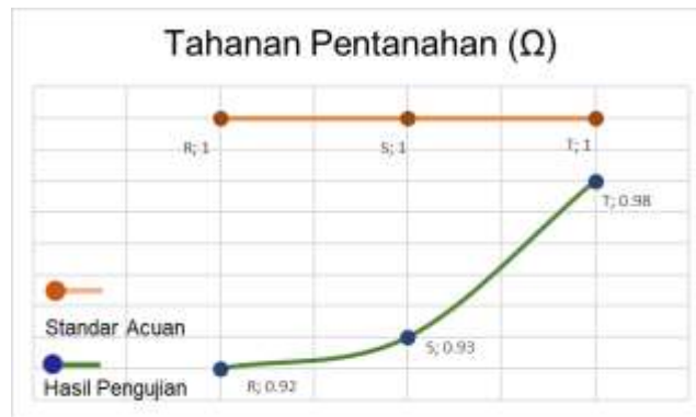
Gambar 6. Hasil Pengujian Tahanan Pentanahan CT
