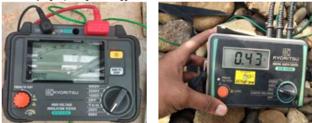
(a) (b) Gambar 3. (a) Alat Uji Tahanan Isolasi (b) Alat Uji Tahanan Pentanahan
